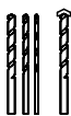
Drill bits: 1/8", 3/16", 1/4" *Masonry drill bits Bohrer: 1/8", 3/16", 1/4" *für die Steinmauer Сверла: 1/8", 3/16", 1/4" *Сверла для каменной стены
