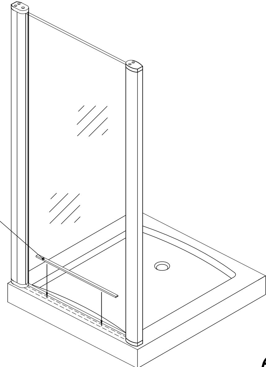
9. Установить силиконовый уплотнитель на низ дверного полотна.
