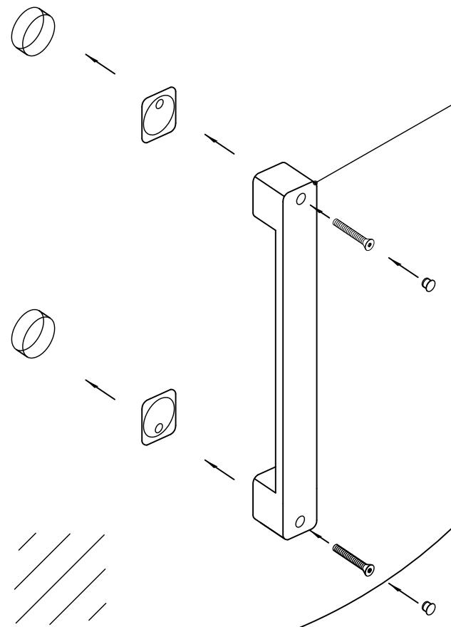
7. Взять порожек (поз.5). Надеть на него концевики (поз.6). Приложить к изделию, как показано на рисунке. В случае необходимости порожек следует отпилить ножовкой по металлу до нужного размера. Концевики дают возможность регулировки до 2 мм с каждой стороны (рис.8).
