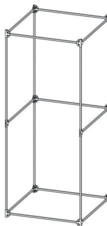
Рисунок 12 – Предварительная фиксация конструкции верхнего уровня
