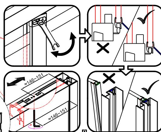
1. Данная модель является реверсивной, поэтому отрегулируйте винт шестигранным ключом, чтобы дверь закрывалась в нужную для вас сторону.
