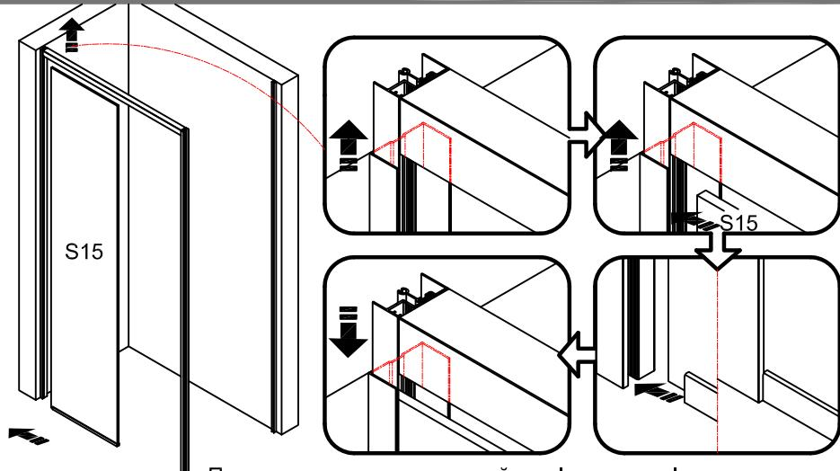
Приподнимите вертикальный профиль и профиль рельса вверх примерно на 1 см, а затем поместите неподвижное стекло в вертикальный профиль, как показано на фото, после этого опустите вертикальный профиль и профиль рельса и вставьте их обратно.
