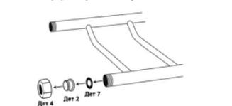
4. Надеваем кольцо на переходник, вкручиваем в кольцо шпильку, затягиваем отверткой. Повторяем ту же операцию с противоположной стороной.
