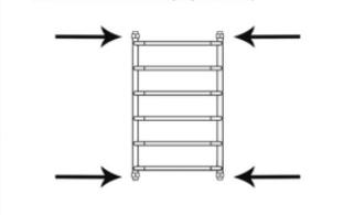
5. Закручиваем краны Маевского в свои гнезда. Проверяем, закрыты ли сами краны Маевского.
