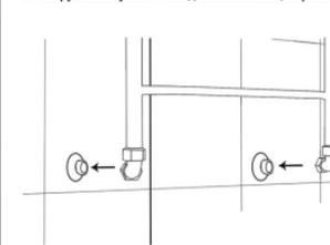
18. Протягиваем все соединения специальным инструментом (разводным ключом).
