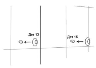
21. Открываем клапан крана Маевского. При помощи отвертки или специального ключа.
