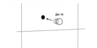
8. Вкладываем прокладки в угловое соединение и накручиваем на полотенцесушитель.
