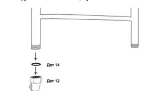
15. В гайку угловое соединение вкладываем прокладки.
