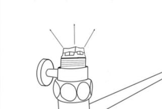
7. На эксцентрики подтягиваем сантехническую нить (в комплект не входит) и вворачиваем в подводку центральной системы отопления или водоснабжения с необходимым количеством витков
