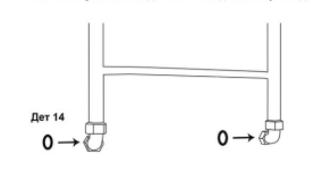
16. Берем полотенцесушитель, вставляем шпильки в держатели и затягиваем шестигранным ключом стопорные винты в держателях
