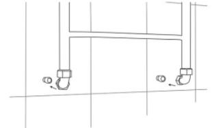
10. Отмечаем места для сверления технологического отверстия под держатели в верхней части полотенцесушителя.
