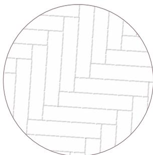
**Мозаичный инженерный паркет „Венгерская ёлка“** – это двухслойная конструкция, в которой верхний слой - ценная древесина европейского дуба, а нижний - высококачественная влагостойкая фанера, с расположенными на кромках пазами и гребнями, предназначенными для соединения паркетных планок между собой. На планках выполнены фаски по всему периметру доски. Паркет изготавливается парами (правым и левым).
