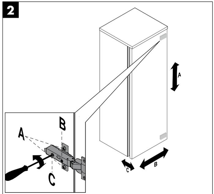
**DÄMPFERVERSTELLUNG** ADJUSTMENT OF DAMPER // RÉGLAGE DE L'ARMORTISSEUR // DEMPER VERSTELLUNG // REGOLAZIONE DE L'ARMORTIZZATORE // РЕГУЛЯЦИЯ АМОРТИЗАТОРА
